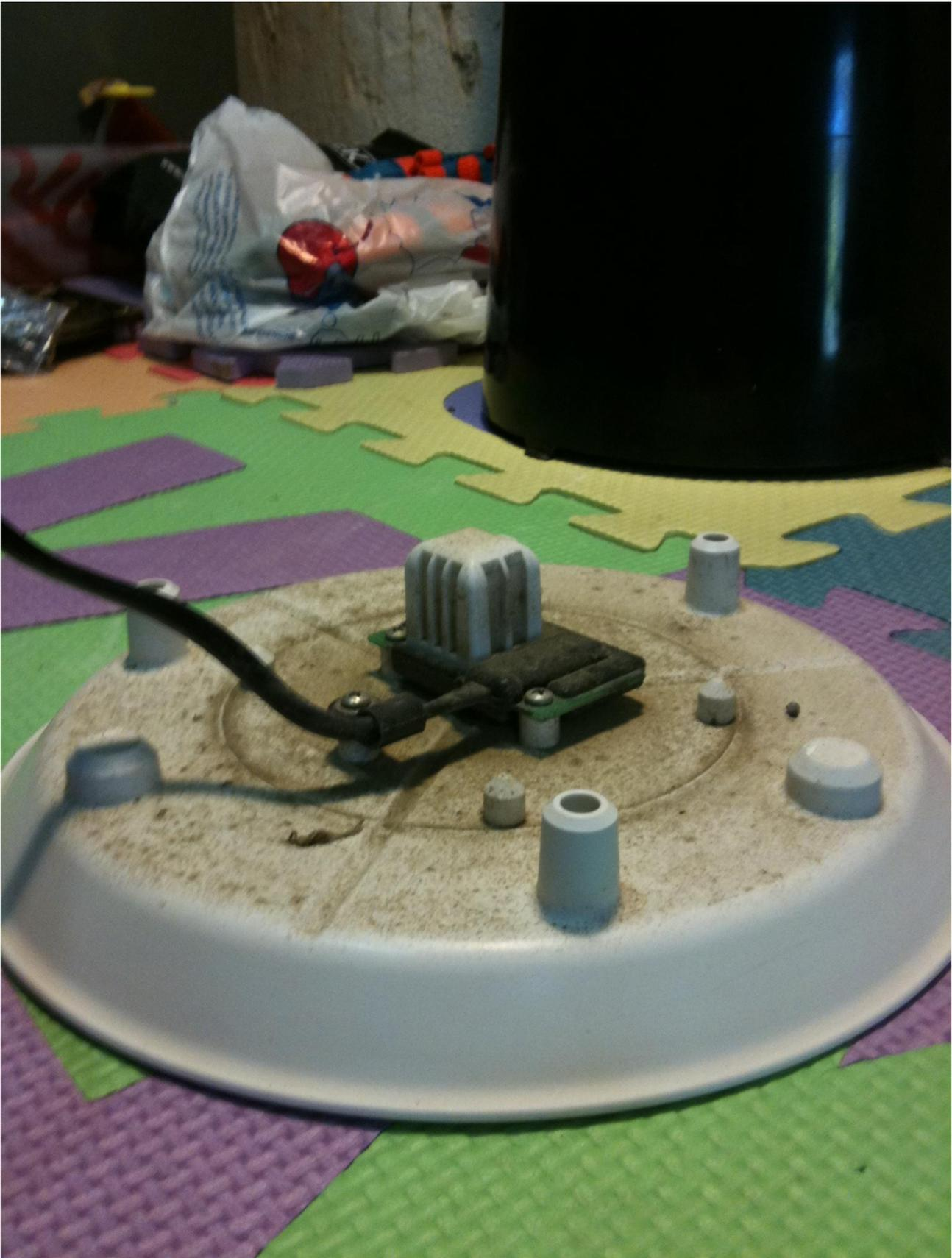
Ora possiamo smontare la protezione del sensore, facendo molta attenzione in quanto potremmo rovinare irrimediabilmente lo stesso. Dobbiamo svitare le tre viti che lo ancorano alla base, girarlo e sganciare le due linguette bianche che si vedono al di sotto (nel mio caso erano parzialmente coperte dai nidi di ragno!):
